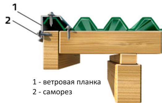
Для примыкания ската к стене применяют угловые планки. Планки, независимо от вида примыкания - продольного или поперечного, следует монтировать с помощью саморезов с шагом 200-300 мм и нахлестом между этими планками около 100 мм и более.
